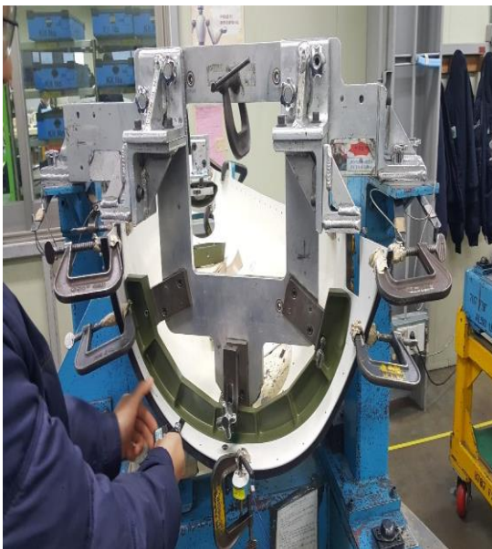
787 FSF FAJ ROOM GAP INSPECTION
