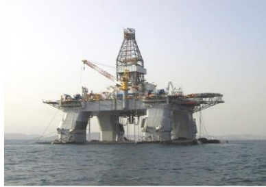
반잠수식 해양구조물 (Semi-submersible Rig)
